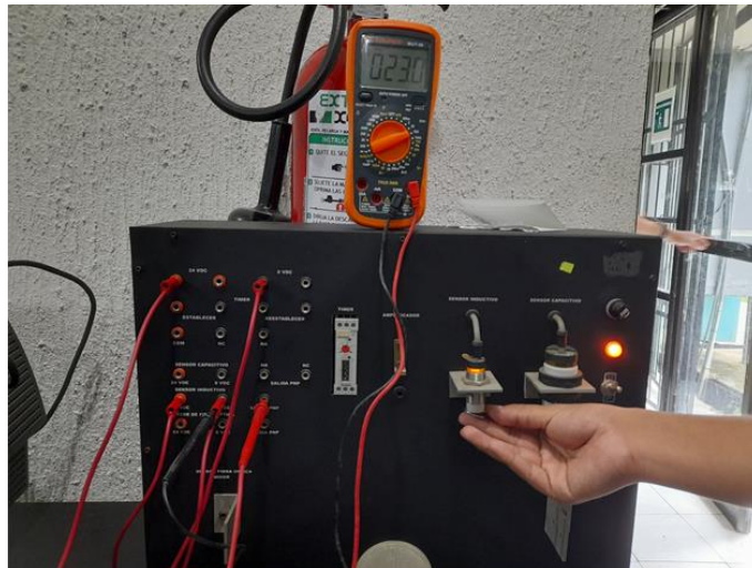
Figura 6. Lectura del voltaje a la salida del sensor al sensar una moneda.
