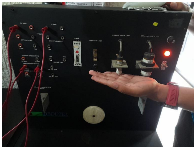
Figura 4. Comportamiento del led indicador al acercar la mano.
