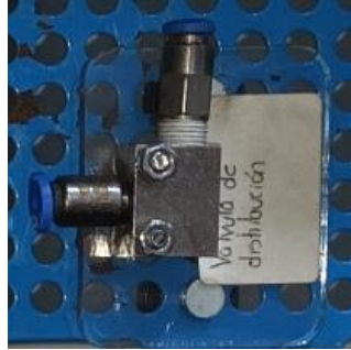
Figura 17. Válvula de distribución.
