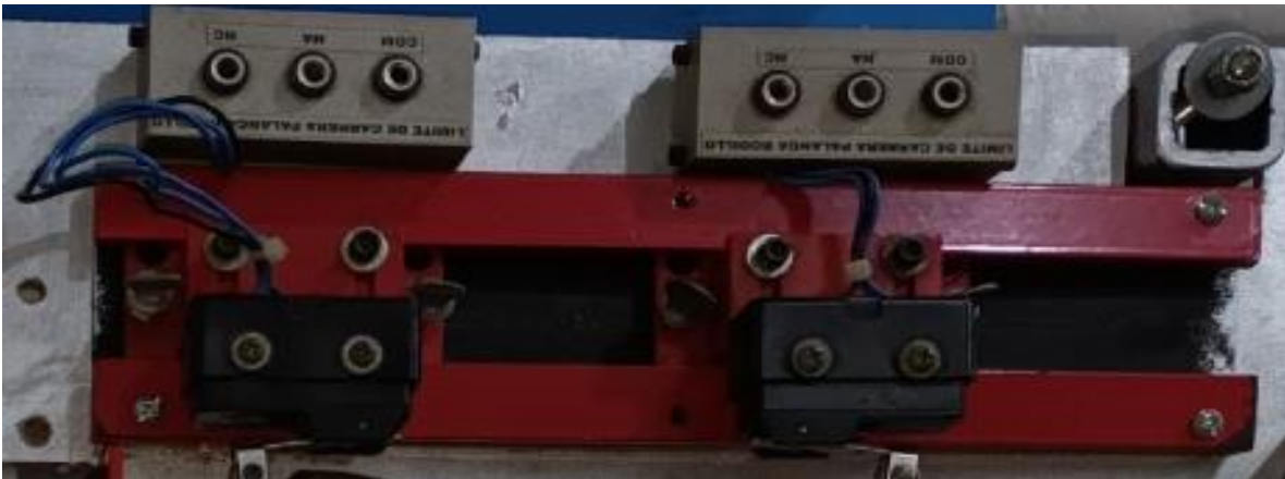
Figura 26. Interruptor de carrera palanca con rodillo.
