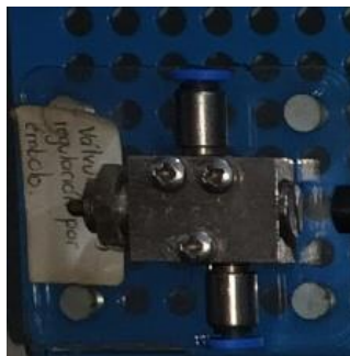
Figura 18. Válvula reguladora por émbolo.
