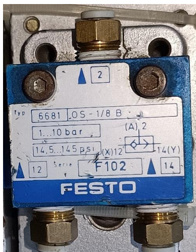
Figura 21. Festo válvula 6681 OS 1/8 B.
