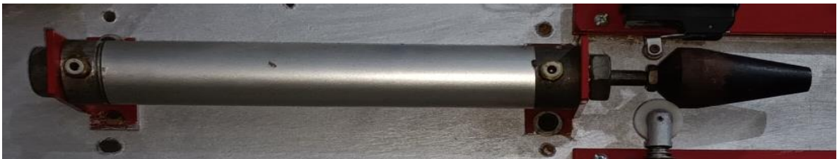
Figura 32. Cilindro de doble efecto.
