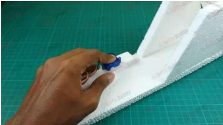
10- Ahora se toma la varilla de hierro y se coloca de la siguiente manera conectándola al soporte de la bola y al servomotor.
