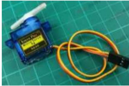
*Figura 25. Servo motor. [15]*
