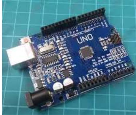
Figura 22. Placa Arduino Uno. [15]
