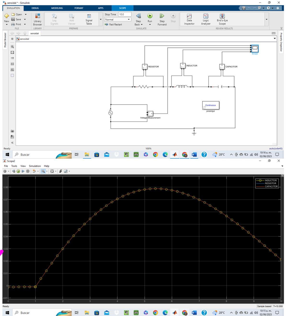
Ilustración 4 Figura 17. Gráfica de la respuesta del circuito RLC conexión en paralelo.
