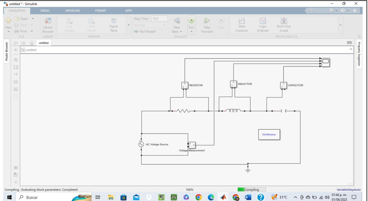
El siguiente diagrama corresponde al ejemplo del caso Sobre amortiguado; se agregaron más elementos scope para observar el comportamiento independiente de cada elemento, R, L y C. La función aplicada como entrada es escalón unitario.
