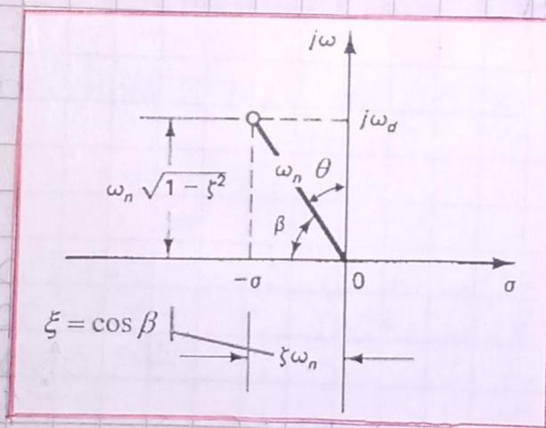
Ubicación de los parámetros: factor de amortiguamiento  $\lambda$ , frecuencia natural  $\omega_n$  y frecuencia natural amortiguada  $\omega_d$ , en el plano complejo  $s(\sigma + j\omega)$ .
