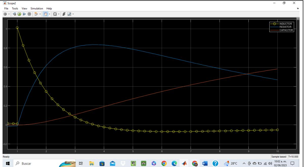
Ilustración 2 Gráfica que muestra el comportamiento del voltaje en los elementos R, L y C ante una entrada
