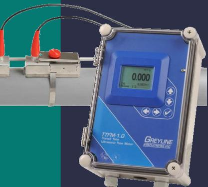
Miden la velocidad del fluido que fluye a través de la tubería, Las dos formas para hacer esto son por tiempo de tránsito o tecnología Doppler. La tecnología Doppler mide la diferencia de frecuencia de las ondas sonoras reflejadas por las burbujas de gas o las partículas en la corriente de flujo.
