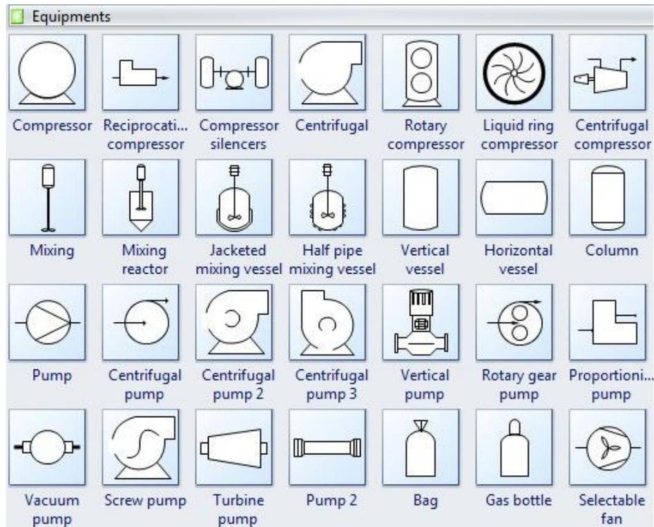
**Compresor:** dispositivo mecánico que toma un medio y lo comprime a un volumen menor.
