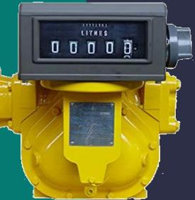
Miden la tasa de flujo volumétrico de un líquido o gas que pasa por el medidor, atrapándolo repetidamente con partes giratorias, que miden el volumen.
