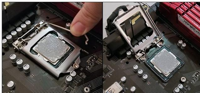
3. Posteriormente se debe comprobar si existe algún pin doblado en el socket, porque si se presenta, se debe de destorcer con mucha precaución utilizando una herramienta adecuada.
