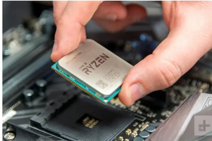
5. Tenemos que retirar la nueva CPU de su embalaje tomándola por los bordes, con la precaución de evitar tocar los pines, identificando el indicador que este presenta en una de las esquinas de la CPU para alinear con el socket de la placa base.
