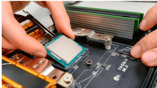
2. Levantar la palanca del socket de la placa base para librar la CPU anterior y retirar con suavidad, se debe de adecuar el socket a la placa base, esto lo realizamos, abriendo el socket de la placa base y levantando la palanca de retención.
