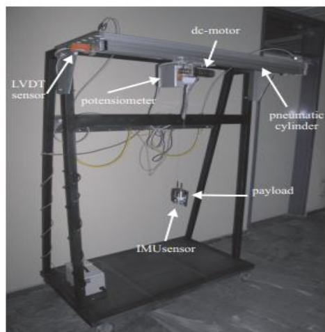
Ilustración 4. Montaje Experimental (VISTA FRONTAL).
