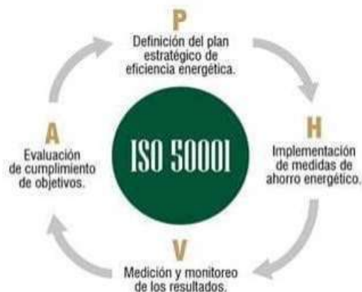
Figura 2. Esquema seguido por la ISO 50001
