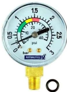
Los manómetros como instrumentos de medición de presión se utilizan para medir la presión de gases o líquidos en recipientes cerrados. Con él podemos distinguir la presión atmosférica de la absoluta, cuyo resultado es, entonces, la presión manométrica. En la industria, los manómetros son empleados comúnmente, ya que muestran de forma precisa la información requerida por los usuarios, incluso a niveles muy grandes de presión.
