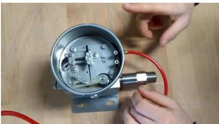
Es un instrumento de medición de la presión el cual posee un fuelle o acordeón, y es a éste a que se le aplica presión y así se estira, y con este movimiento hará que se mueva una aguja la cual indicará la presión.
