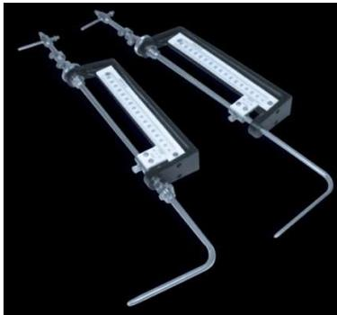
El Tubot de Pitot es útil para medir la velocidad del viento, cuantificar las velocidades de aire y gases industriales. En otras palabras, este instrumento sirve para medir la velocidad que puede alcanzar la corriente de flujo. aunque no es específicamente un instrumento de medición de presión, combinado con el barómetro puede ser de gran utilidad para medir condiciones atmosféricas puntuales.
