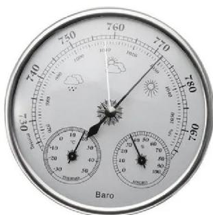
El barómetro es el instrumento de medición de presión idóneo cuando lo que se busca es medir la presión atmosférica. Los barómetros más antiguos precisos que se conocen poseían una columna de líquido que equivale al peso de la atmósfera, y este estaba encerrado en un tubo que ofrecía la visión de la presión existente en un ambiente determinado.
