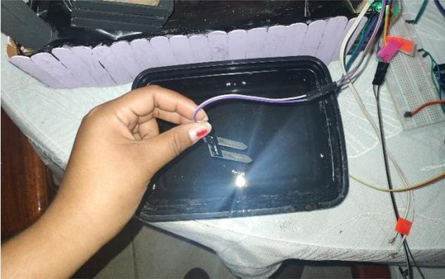
Se observa que al variar la humedad del suelo con el sensor FC-28 la bomba se activa u apaga según sea el caso, por ejemplo si la humedad es alta, la bomba se apaga pero si el sensor detecta una humedad seca, la bomba se activa:
