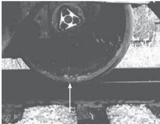
**Figura 19. La rueda de ferrocarril puede considerarse como un cuerpo rígido sobre el que actúa la fuerza concentrada del riel.**
