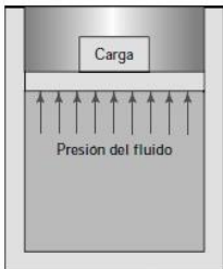
FIGURA 1.5 Ilustración de la presión de un fluido que soporta una carga.
