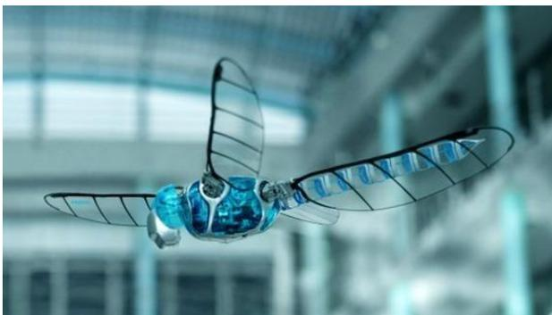
Este mecanismo consta de un par de alas modeladas con la misma forma de un ala real, las alas están diseñadas para efectuar tres tipos de rotaciones adelantadas, simétricas o en atraso, puede volar en todas direcciones, así como elevarse en
