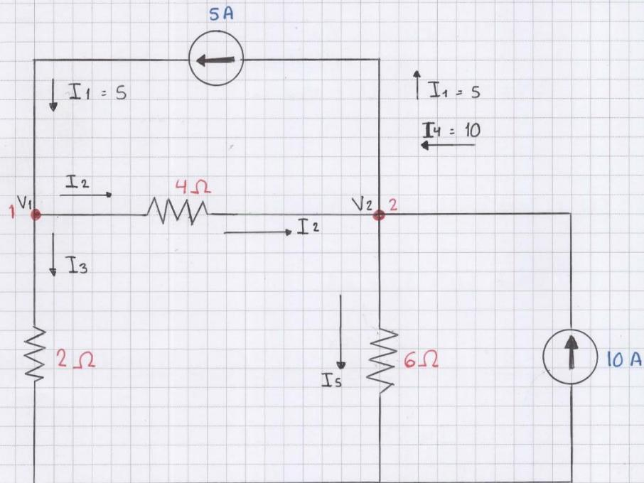
\* EN EL NODO 1, LA APLICACIÓN DE LA LCK Y LA LEY DE OHM PRODUCE. /
