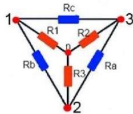
Para obtener los resistores equivalentes  $R_1$ ,  $R_2$  y  $R_3$  en la red en estrella, comparamos las dos redes y nos aseguramos que la resistencia entre cada par de nodos en la red en delta sea la misma que la resistencia entre el mismo par de nodos en la red en estrella.
