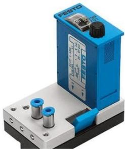
**VÁLVULA DE TEMPORIZADOR:** la válvula temporizadora está compuesta por una válvula neumática de 3/2 vías, una válvula reguladora de caudal unidireccional y un pequeño depósito. Cuando se alcanza la presión necesaria en la conexión de pilotaje 12, la válvula de 3/2 vías conmuta y el caudal pasa libremente de 1 a 2.
