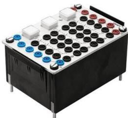
**PULSADOR NA (NORMALMENTE ABIERTO):** interruptor que se cierra durante el accionamiento y que se abre de nuevo inmediatamente si se deja de pulsar.
