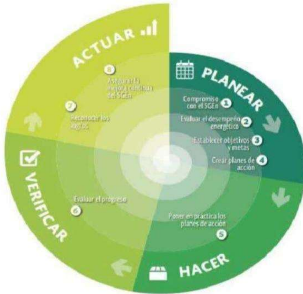
Figura 5: Etapas para el diseño e implementación de un SGE en el contexto del ciclo de mejora continua (PHVA)
