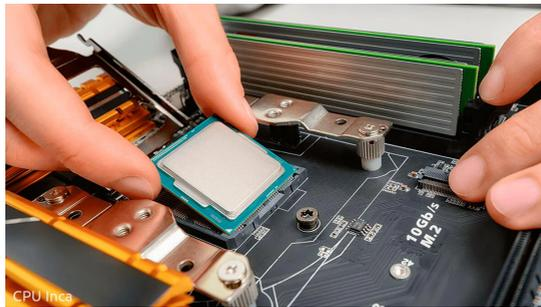
2. Levantar la palanca del socket de la placa base para librar la CPU anterior y retirar con suavidad, se debe de adecuar el socket a la placa base, esto lo realizamos, abriendo el socket de la placa base y levantando la palanca de retención.
