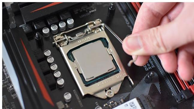
7. Como penúltimo paso, aplicamos la pasta térmica, en la parte superior de la CPU, esta nos ayudará con la transferencia de calor entre la CPU y el disipador.
