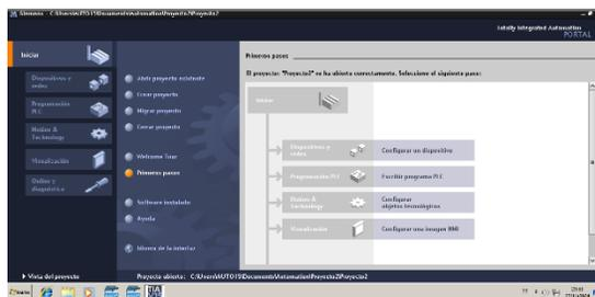
Posterior a eso nos muestra una ventana como la que esta al lado en donde debemos seleccionar la opción de “Configurar un dispositivo” le damos clic y nos aparece una ventana en donde debemos seleccionar el tipo y modelo de PLC que vamos a programar.
