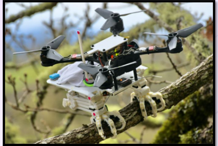
Ilustración 5. SNAG demostró su capacidad para aterrizar y posarse en ramas de árboles
