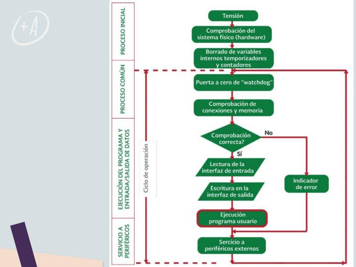
Tiempo de ejecución y control en tiempo real. El tiempo total que el Controlador Lógico Programable emplea para realizar un ciclo de operación se llama tiempo de ejecución de ciclo de operación o más sencillamente tiempo de ciclo "Scan time". Dicho tiempo depende de:
