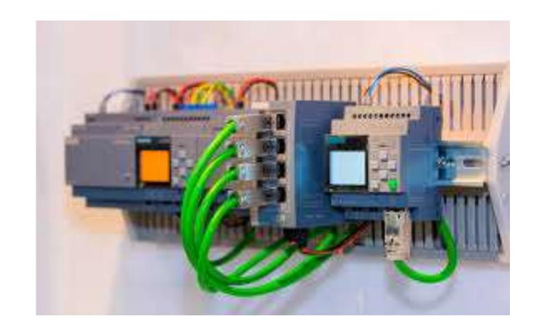
Es una computadora industrial que usa la ingeniería para la automatización de procesos y tiene como finalidad, que las máquinas desarrollen efectivamente todos los sistemas que la componen. Gracias a estas bondades los PLC se han convertido en una herramienta fundamental para el desarrollo tecnológico de las industrias y todo el entorno social.
