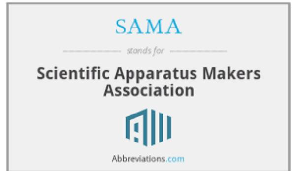
La complejidad de las estrategias usadas para el control de la combustión requiere una notación que exceda los Diagramas de Proceso e Instrumentación (P&IDs) estándar de la ISA (Sociedad de Instrumentación, Sistemas y Automatización). La Asociación Científica de Fabricantes de Aparatos (SAMA) ha desarrollado tal notación y esto se utiliza comúnmente para definir estrategias de control de combustión.
