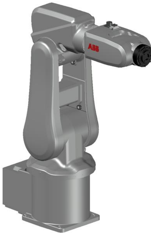
Figura 1.- Brazo Robótico ABB IRB 120.
