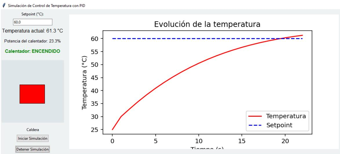
Después de sobrepasar el valor del setpoint establecido, la tonalidad del grafico es roja, simulando un estado de alerta, el cual inicia un proceso inverso para controlar el valor de la temperatura del proceso.
