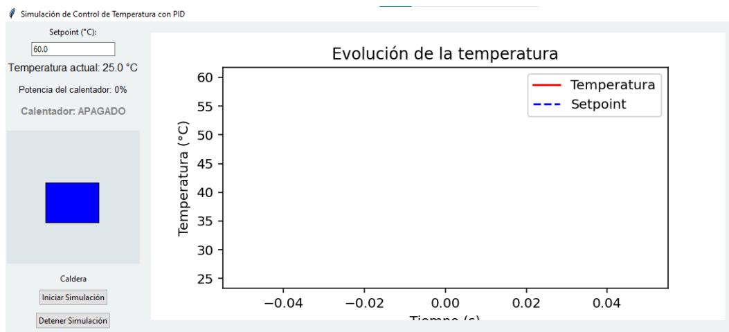
Esta es la interfaz diseñada, en la cual se pueden apreciar los valores iniciales de la temperatura de nuestro proceso, en este caso se eligió una caldera hipotética, de igual forma podemos apreciar el valor del setpoint, en este caso es de 60°, la ilustración de la caldera cambiara de color conforme aumente o disminuya la temperatura del proceso.
