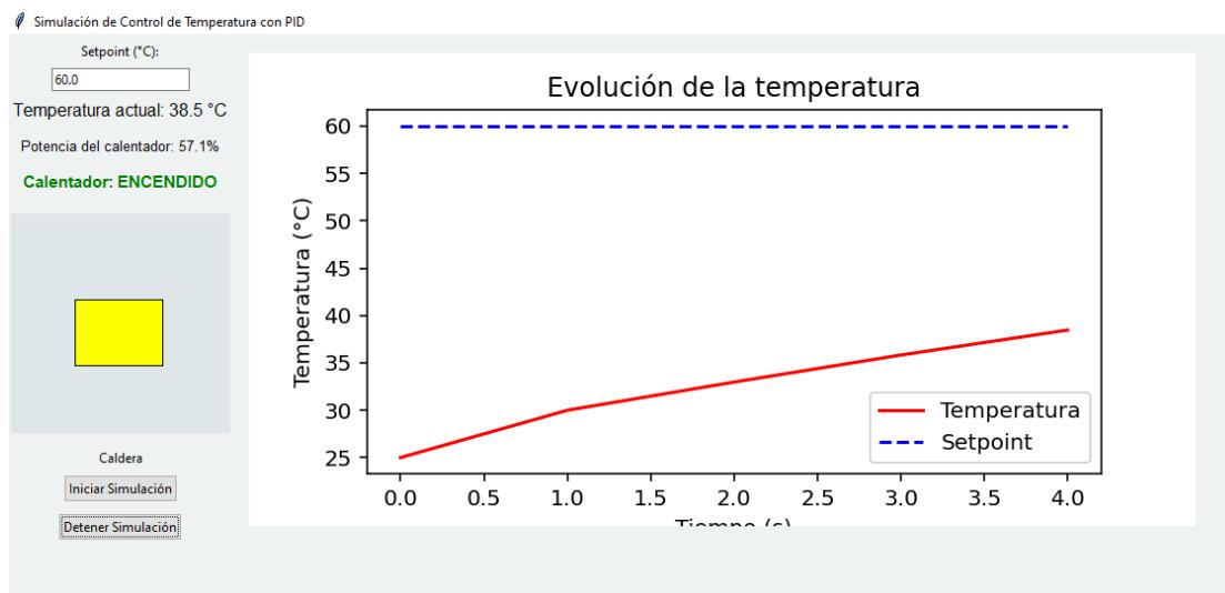
Al iniciar con la simulación, se aprecia que la caldera cambia a un color amarillo cuando la temperatura sobrepasa los 35°, mientras que la potencia del calentador se encuentra a un 57% y sigue en ascenso para llegar al valor deseado.
